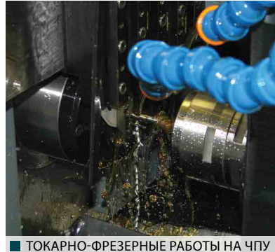
■ ТОКАРНО-ФРЕЗЕРНЫЕ РАБОТЫ НА ЧПУ
